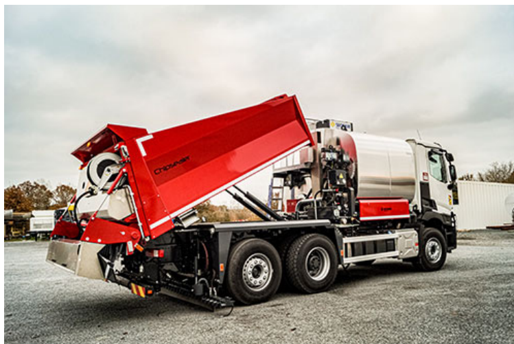
Рисунок 3 – CHIPSEALER A - універсальна машина, що поєднує в собі можливість одночасного розливу емульсії та розподілу щебеню.
